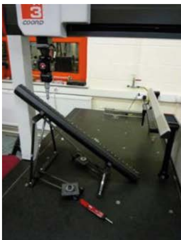
Calibración por patrones calibrados (izquierda), ball bar (centro), laser tracker (derecha)
