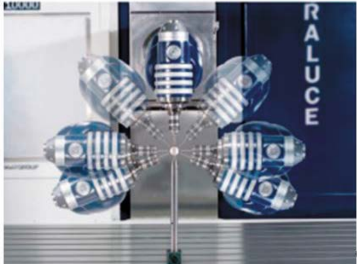
Sistema de medición de ejes giratorios (izquierda) ball bar (derecha) medidor sobre esfera
